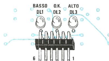
Fig. 9 Dal lato opposto invece, andranno inseriti i tre diodi led ed il connettore a cinque terminali che andrà innestato in seguito sul circuito base LX.640 (vedi foto e fig. 7).
